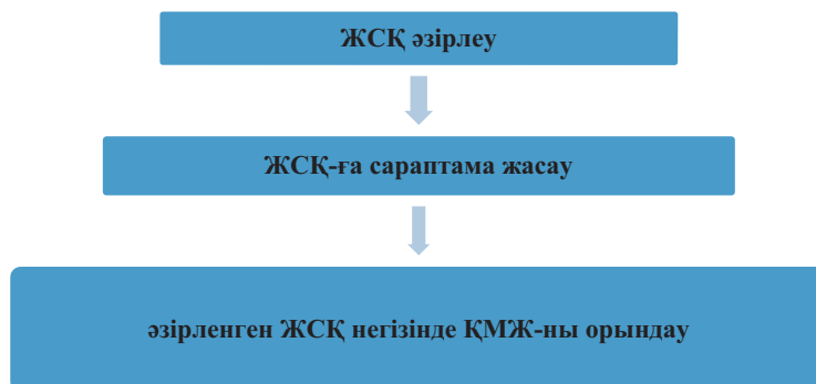
Сурет 5 – ЖСҚ-ны әзірлеу сатылары Ескерту – ЖСҚ – жобалық-сметалық құжаттама, ҚМЖ – құрылыс-монтаж жұмыстары, [1] дереккөзі негізінде авторалармен құрастырылған
