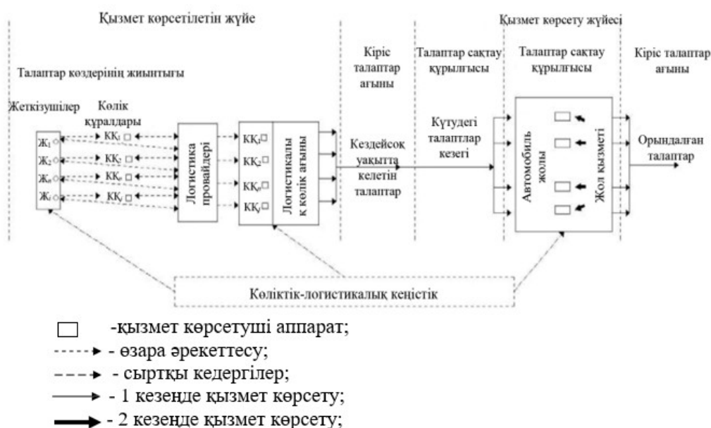
Сурет 1 – Кезек жүйесі ретінде жүк көлік жүйесі элементтерінің өзара әрекеттесуінің құрылымдық сызбасы
